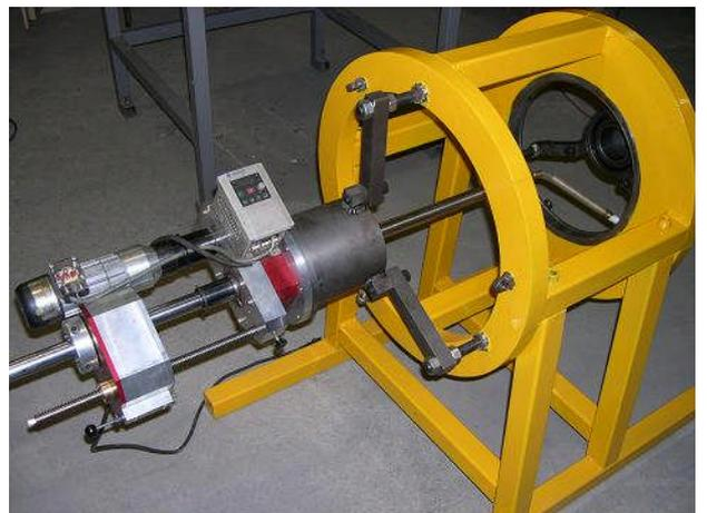
*Este proceso es automático y utiliza solamente un motor para la rotación. El ajuste mecánico del desplazamiento permite una soldadura sin defectos.*
