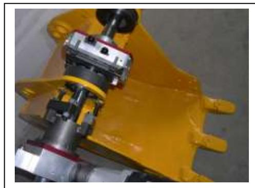
**Motorisation standard :** Electrique réversible avec Réduction permettant une augmentation du couple.
